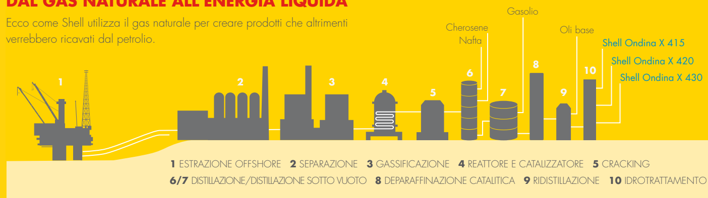
Figura 1: Il processo GTL converte il gas naturale in carburanti puliti e oli base di elevata qualità mediante la sintesi di Fischer-Tropsch; gli oli base GTL vengono quindi ulteriormente lavorati per produrre oli bianchi medicinali di alta qualità. Fonte: Shell.
