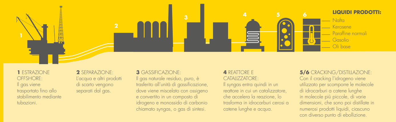
Figura 2: il processo GTL converte gas naturale a combustione pulita in carburanti puliti e oli base di alta qualità mediante la sintesi di Fischer-Tropsch.
